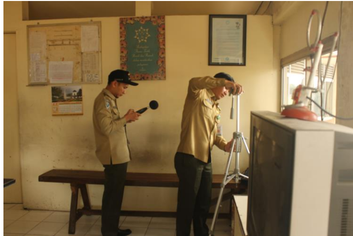
Gambar 9 Pengukuran Kebisingan dengan Alat Sound Level Meter
